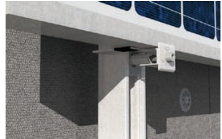
Detalle: Soporte de módulo fotovoltaico en el soporte BR FV
